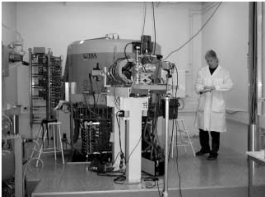
Radiokemian laboratorion kompakti 10 MeV:n protoni- / 5MeV:n deuteronikiihdytin. Vierellä yli-insinööri FT Kerttuli Helariutta joka vastaa syklotronin käytöstä.
