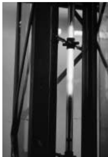
REWET-I keltahehkuisena valmiina hätäjähdytysveden ruiskutukseen lämmönsiirtokriisin jälkeisen jälleenkastumisnopeuden tutkimiseksi.
