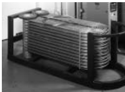
Korkeamman PACTEL-höyrystimen primääripiiriin lämmönvaihtoputket.
