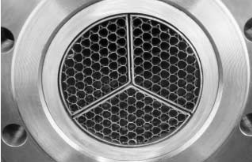
PACTELin sydämen välitukihila, jossa on paikat 144 polttoainesauvalle kolmesta eri polttoainenipusta.
