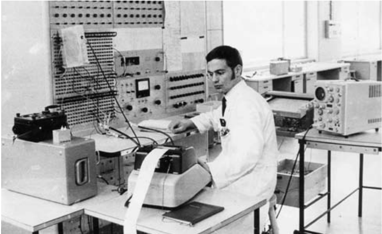
Skribenten utför reaktorbrusmätningar på FiR 1 reaktorn ca. 1964 med analogi-räknemaskinen PACIT och anslutna instrument.
