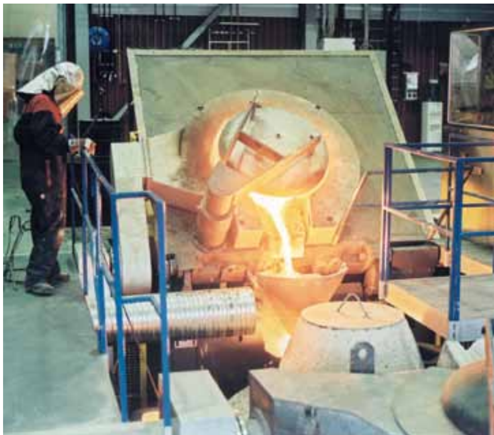
Radioaktiivista metallijätettä käsitellään sulatuslaitoksella. Lähde: Studsvik
