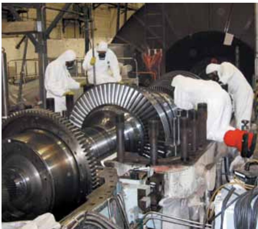
Nyinstallerade snabbstängningsservon undersöks. De aktiveras om turbinen behöver kopplas ur och högtrycksventilerna ska stängas snabbt. Foto: Patrik Tegelberg
